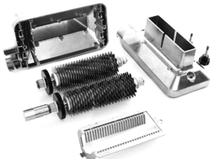
Rys. 13. Moduł kotleciarki rozłożony do czyszczenia
