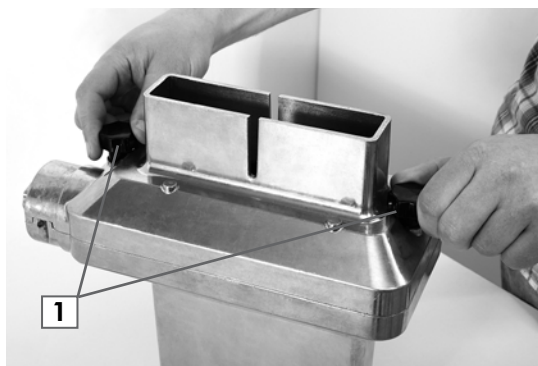
Rys. 7. Rozbieranie modułu kotleciarki
