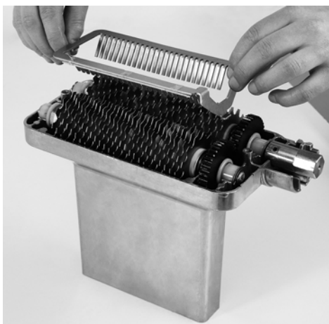
Rys. 9 Demontaż elementów modułu
